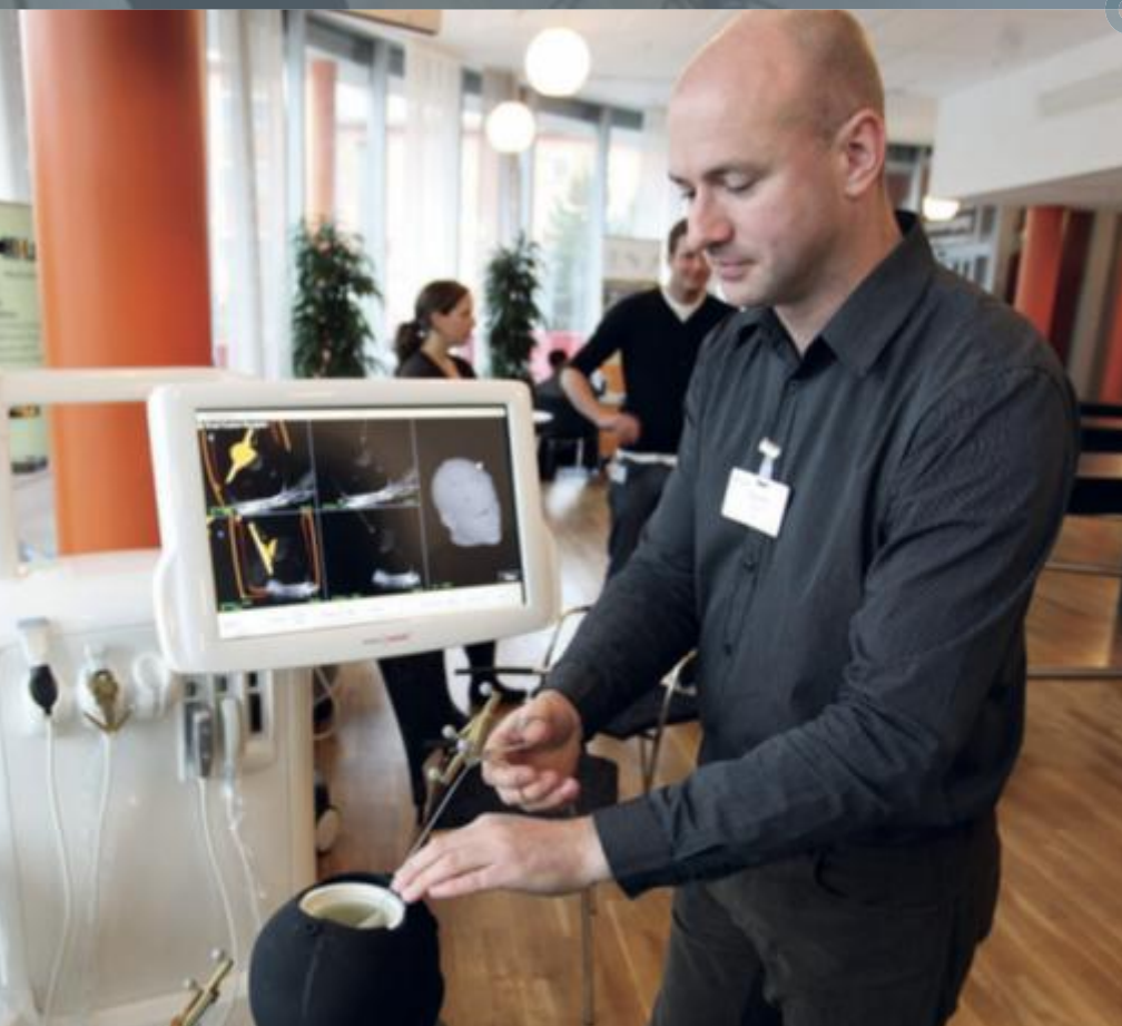
NAVIGASJON: Sonowand er ett av spin-off-selskapene fra trondheimsmiljøet. Her viser systemutvikler Torgrim Lie i Sonowand frem hvordan systemet deres følger med på kirurgens instrumenter og gir kontinuerlig oversikt på bilder av hjernen.
